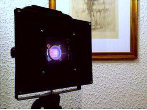
CR500 e' raffreddata per convezione, non utilizza ventole o altre parti in movimento. E' sigillata ed e' protetta da infiltrazioni di polvere o liquidi, adatta quindi per un utilizzo in cantiere. Fornita con occhiali di protezione trasparenti.
