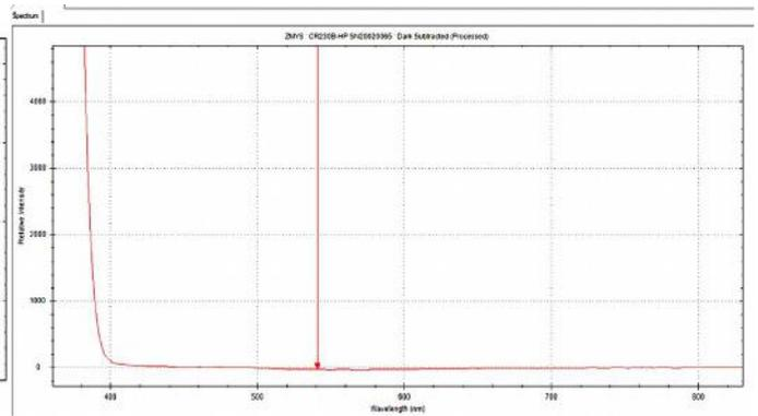
CR500 ha una emissione particolarmente curata, le sue emissioni nello spettro del Visibile e dell'Infrarosso sono trascurabili, consentendo di apprezzare anche minime fluorescenze.
