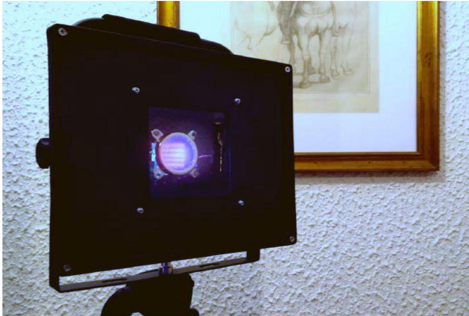
Sorgente UV ad Alta Potenza emessa (15 Watt), filtrata con emissione pura (emissione inferiore allo 0,5% a 400 nm, rispetto al picco di emissione)
